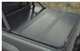
Chapas compuestas en tres capas pintadas en poliéster horneado a 200 grados.
